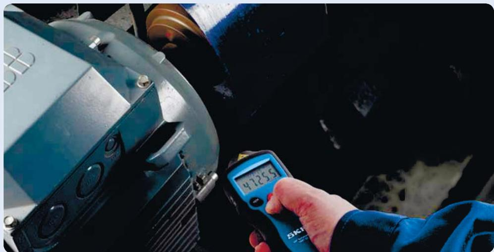
Оптическая лазерная система обеспечивает простое и быстрое измерение на безопасном расстоянии от вращающегося оборудования.
